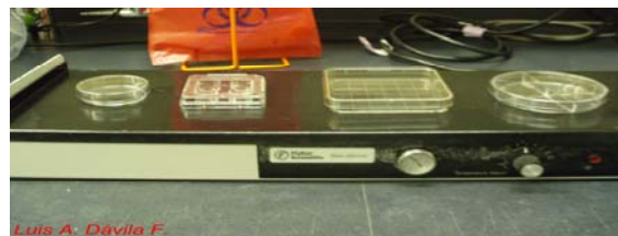
Figura 2.- Placas de cultivo necesarios para FIV, sobre Laminilla Térmica a 38.5°C de izq. a der. Placa Petri Falcón 60 X15 que se usara para preparar las microgotas, Placa nunclon con 4 Wells (depósitos ó compartimentos) para Fertilización, Placa (Grid) de búsqueda y colección de CCOs, Placa X para lavar y clasificar los Ovocitos (CCOs {Complejos Cumulus Ovocitos}) y Embriones, todos los contenedores y placas deberán estar listos y estériles, a 38.5°C sobre la platina térmica. Pueden ser comprados en Fisher Científica .
