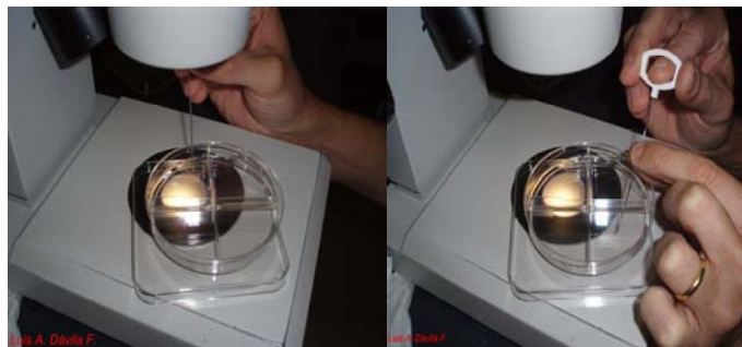
Figura. 3 Uso del wiretrol usando una mano (Foto Izquierda), o dos manos (Foto de la Derecha).
